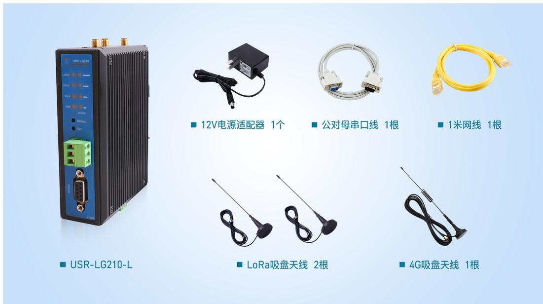
集中器支持的 LoRa 频率为410MHz~510MHz，标配 LoRa 天线支持的频段为 470~510MHz，如果用户设置的 LoRa 频率超过天线所支持的频率范围，通信质量会差，用户可根据使用需要，自行更换支持所设置频段的的天线。
