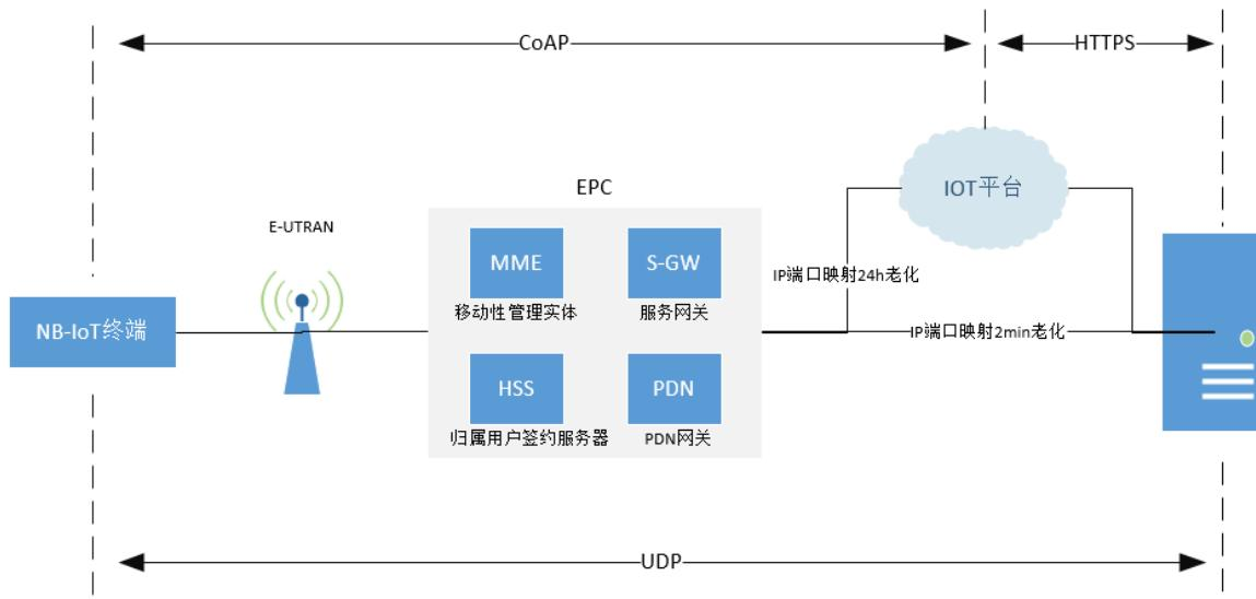
但是需要注意的是：由于 UDP 通信方式，终端通过核心网 EPC 与其他公网的服务器通信时，EPC 会将内网的 IP 映射成一个外网的 IP 加端口，这一映射关系存在老化机制。实际测试发现：如果成功入网的设备超过 2 分钟不与公网服务器进行数据交互，则上次通信的 IP 及端口映射关系失效，此时即便终端处于 eDRX 甚至 DRX 工作模式，公网的服务器无法通过上次成功通信的 IP 及端口与终端进行通信，除非终端进入 PSM 后重新上报数据。
