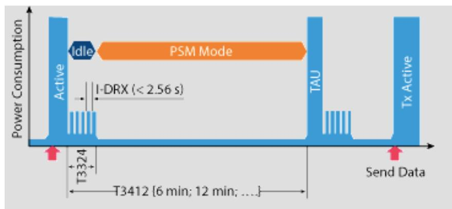
下面是我的电信 SIM 卡的 TAU 是 10 分钟，那么对应的电流显示可以看到每间隔 10 分钟会有一次电流的变化：
