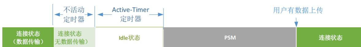
首先，连接状态中数据传输对应 Connected 发射电流，数据发送完成后进入无数据传输的连接状态，此时对应 Connected 接收电流，这部分存在一个不活动定时器，这个定时器有核心网配置，目前约 20 秒时间，随
