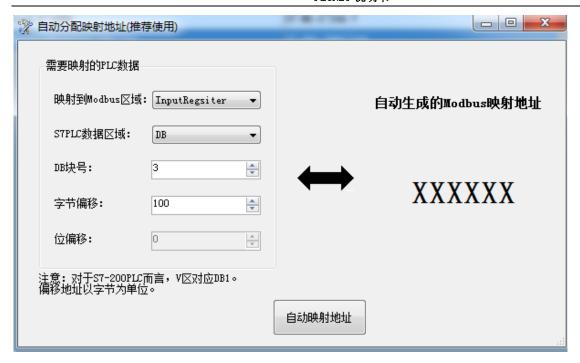
4)映射表编辑完成后,可以通过地址查询确定对应关系,比如要查询 DB1.DBW0 对应的 modbus 地址:点击【映射地址查询】,按如下设置,点击【查询】按钮,可以查询到对应的 Modbus 映射地址。
