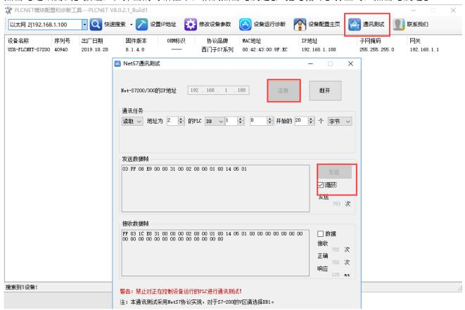
这里我们读取了 PLC 的 MB0~MB19 共 20 个字节的数据,如果通讯正常,则会返回 MB0~MB19 共 20 个字节的数据(最直观的方法: 如果接收次数和正确次数一直是累加的话,表面通讯正常),可以借此来判断 PLCNET-S7 模块、PLC、上位机之间的以太网连接是否正常。
