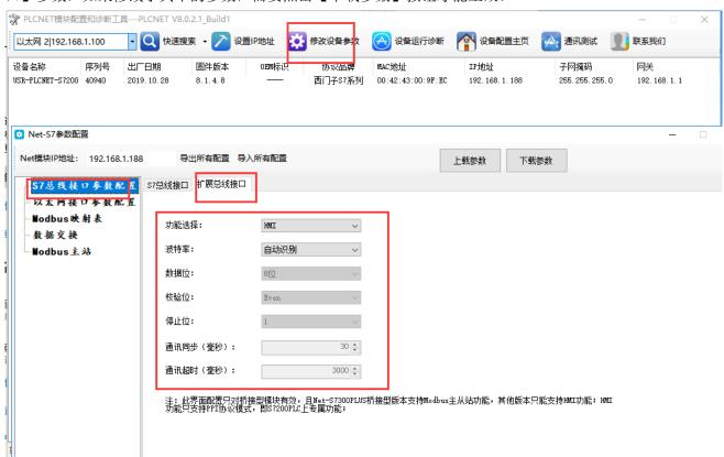
波特率:推荐选择自动识别,如果你知道触摸屏通讯口的波特率,也可以手动设定波特率。 注意:此界面配置只对桥接型模块有效。
