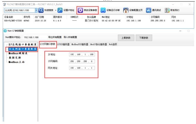
IP 地址、子网掩码、网关地址分别为 PLCNET-S7 的 ip 地址、子网掩码、网关。
