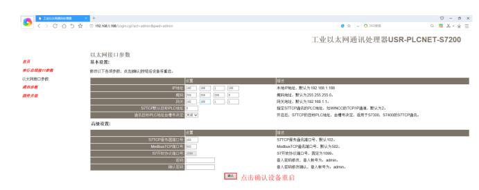
设置 PLCNET-S7 的 IP 地址、掩码和网关(即路由器的地址);
