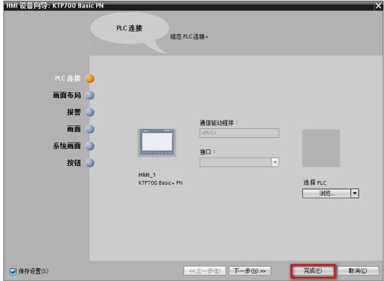
3、给触摸屏分配 IP 地址(必须和 PLCNET 模块的 IP 地址在同一网段);
