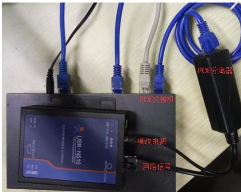
图 4. POE 分离器配套使用（POE 交换机供电）
