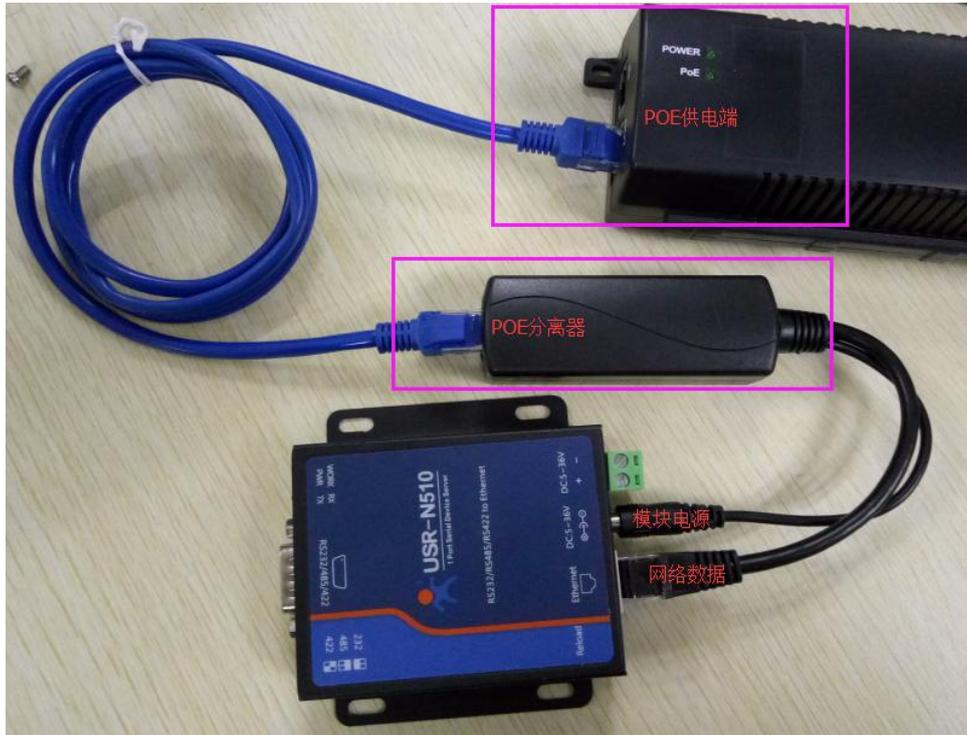
图 3. POE 分离器配套使用（POE 电源供电）
