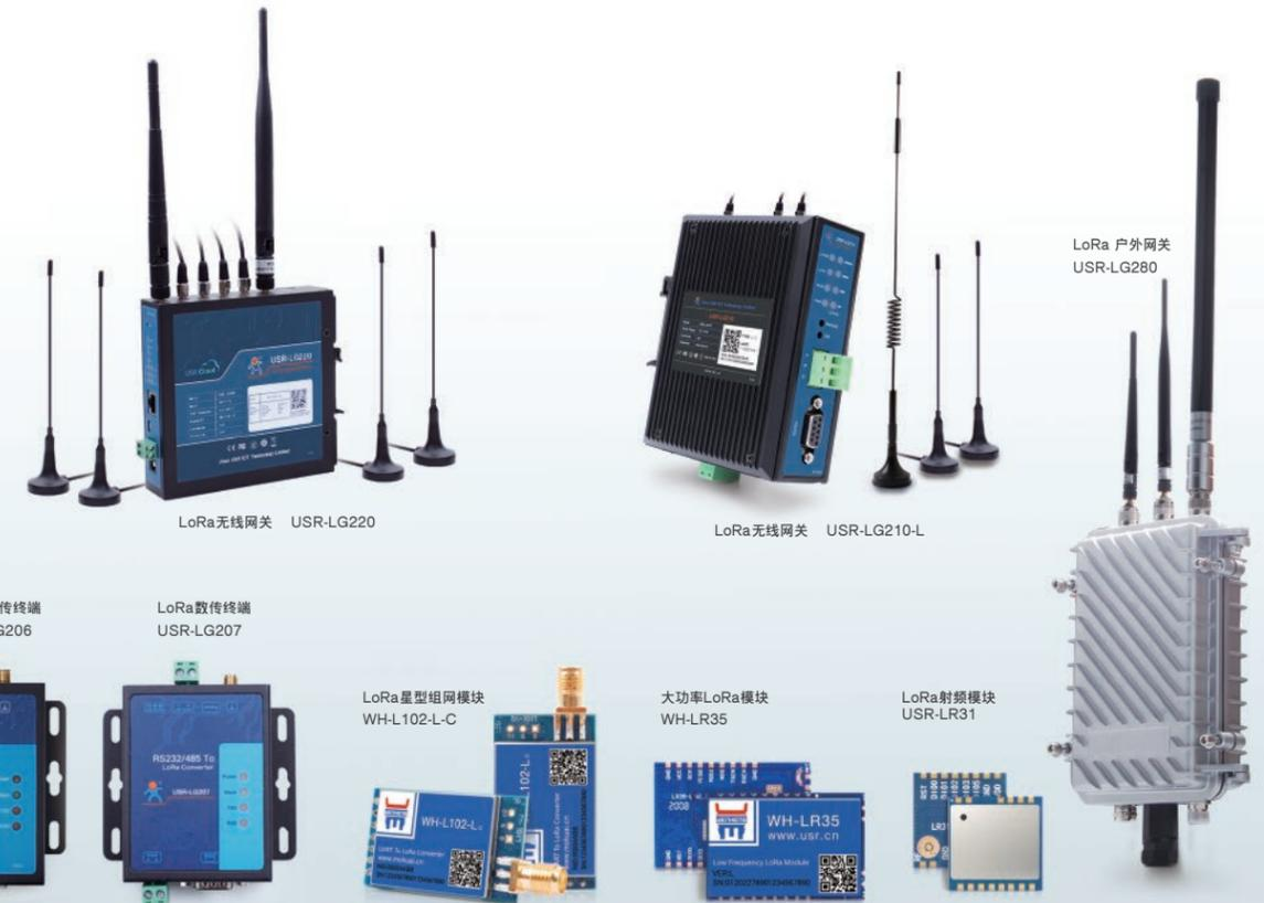
LoRa是LPWAN通信技术的一种，是基于扩频技术的超远距离无线传输方案，主要在433、868MHz等全球免费频段运行。有人LoRa产品具有远距离、低功耗、多节点、低成本的产品特性，目前已在智能表计、智慧农业、烟感报警、油田数据监测等多个场景发挥重要作用。有人LoRa烟感底座采用LoRa无线传输技术，功耗低、穿透强劲、免布线、成本低、支持云服务短信/微信推送功能，与烟感报警器搭配使用，预警效果更佳。
