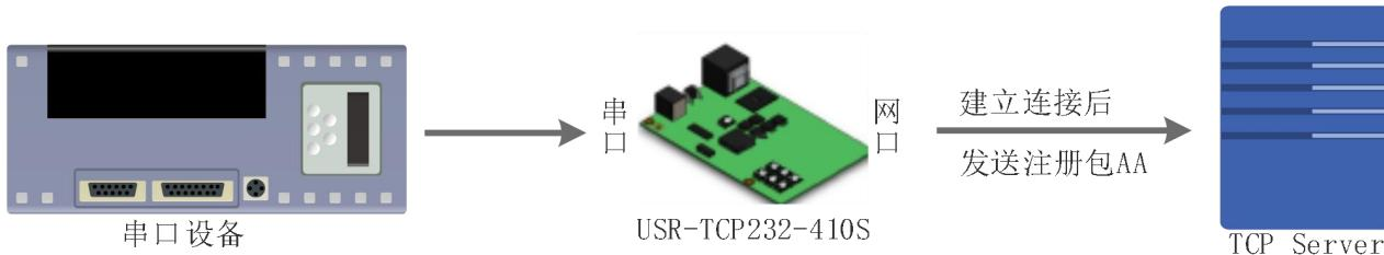
图 46 建立连接发送注册包
