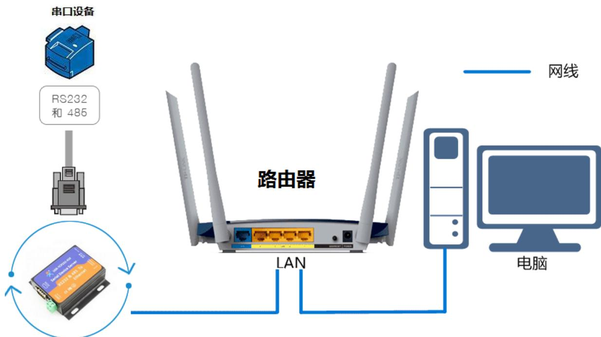
◆ 功能介绍：串口服务器网线连接路由器，进行通信，通信成功的前提是，串口服务器的 IP 和路由器在一个网段。子网掩码网关必须与路由器 LAN 口一致才能通信。
