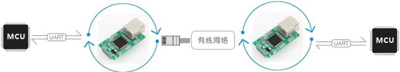
◆ 实现功能：两个串口设备之前是采用串口进行通信，现在由于现场环境，距离和布线的问题，需要采用两个网络模块实现数据对发的功能来实现两个串口设备的串口通信。串口设备连接一个串口服务器，另外一个串口设备连接一个串口服务器，两个串口服务器之间通过网线或者路由器进行通信。
