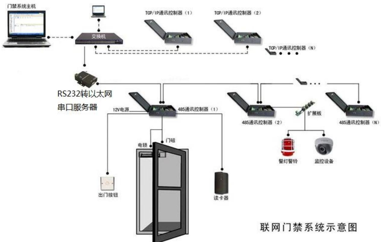
◆ 应用环境：楼宇智能化控制，安防监控方面对门禁集中管理控制的应用比较广泛，大部分的楼宇门禁控制器是采用 RS485 进行通信，RS485 在一个总线上挂多个门禁控制机，实现 485 总线控制多个设备的功能，随着管理的方便性和施工的简易型，大部分楼宇都有先用的网络环境，可以采用 485 转网络的设备，将数据通过网络传输到中控机房，用于集中管理。
