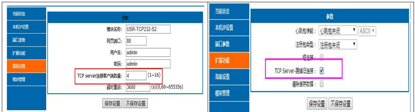
图 37. TCP Server 连接 Client 最大值
