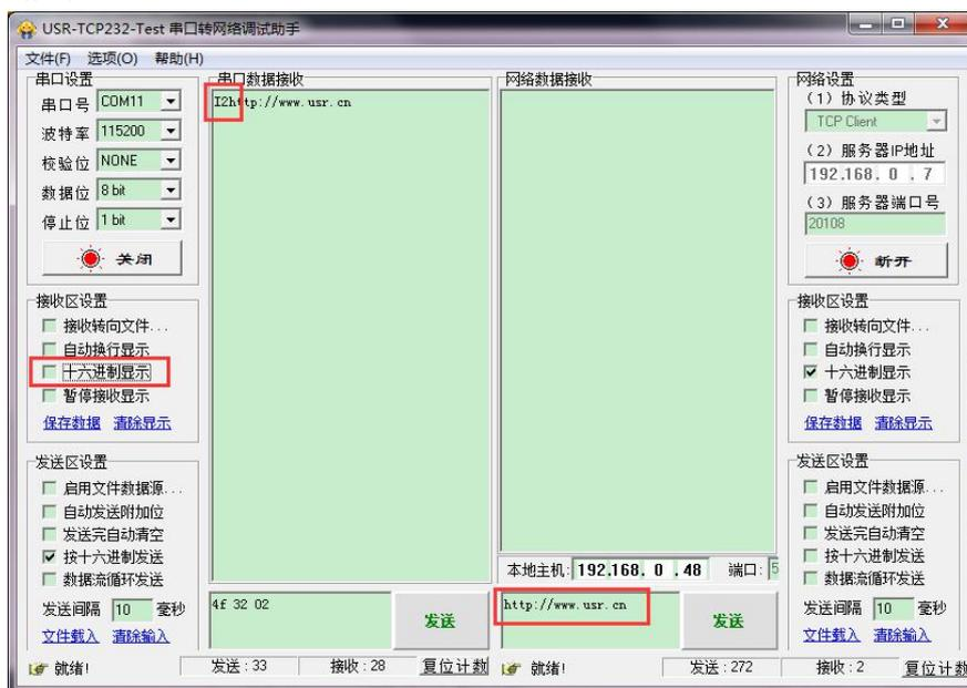
图 38. Index 功能数据传输示例图
