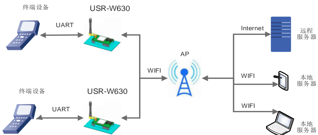
图 8 串口服务器作为 STA 的应用场景
