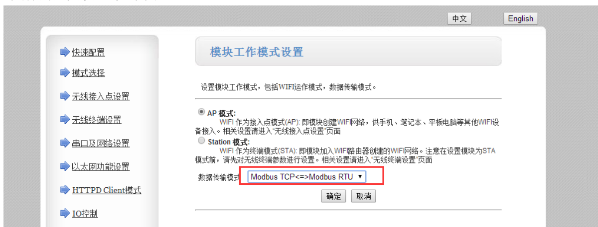
图 16 网页设置 Modbus RTU<=>Modbus TCP
