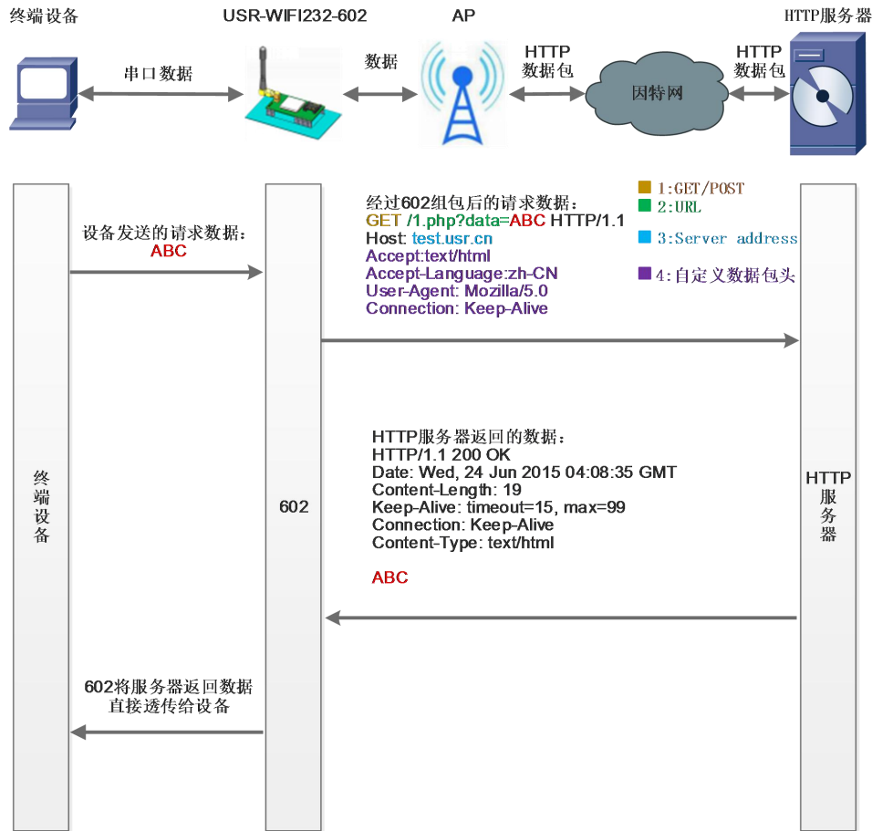
图 15 HTTPD Client 功能框图
