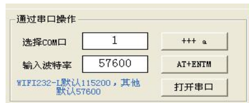
图 27 设置软件串口参数示意图
