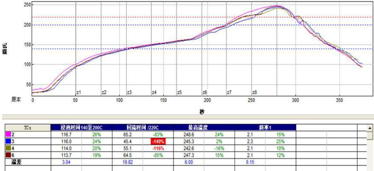
图片20 回流焊焊接温度曲线图
