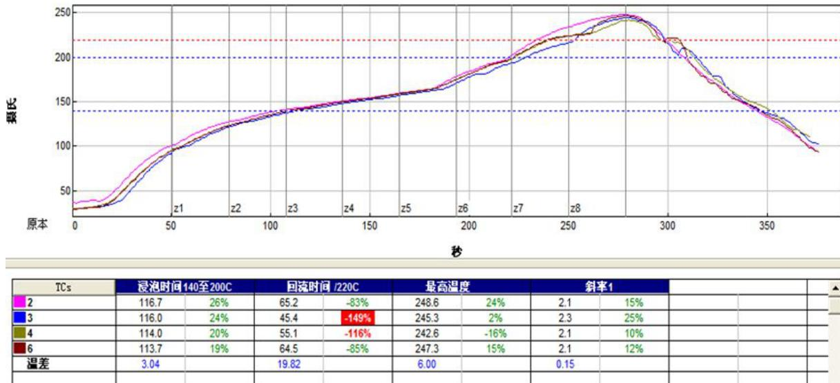
图片19 回流焊接温度曲线图
