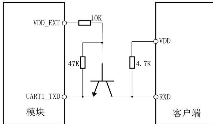
图片9 模块 TXD 电平转换电路
