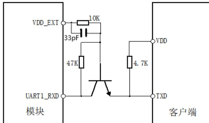
图片10 模块 RXD 电平转换电路
