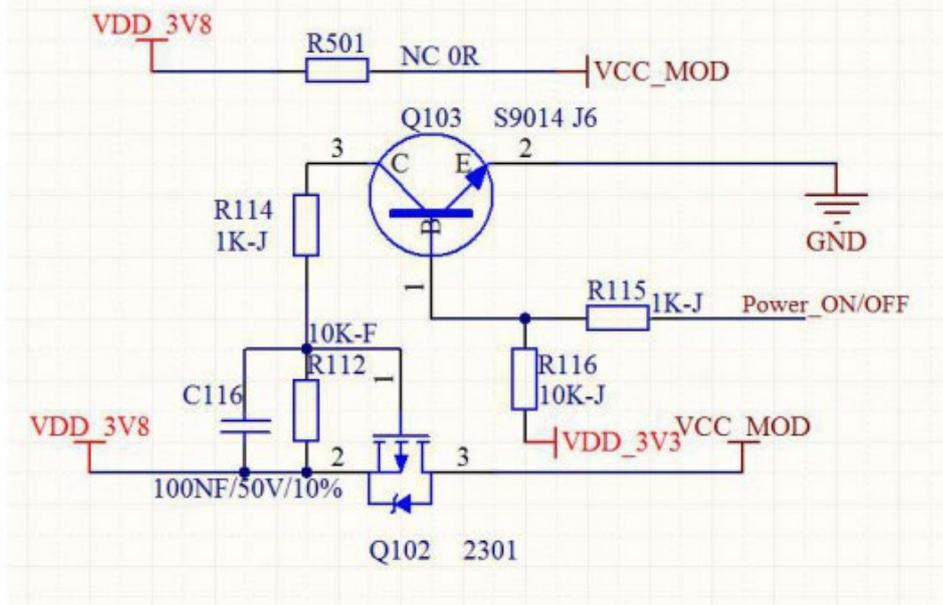
图片7 模块电源控制参考电路
