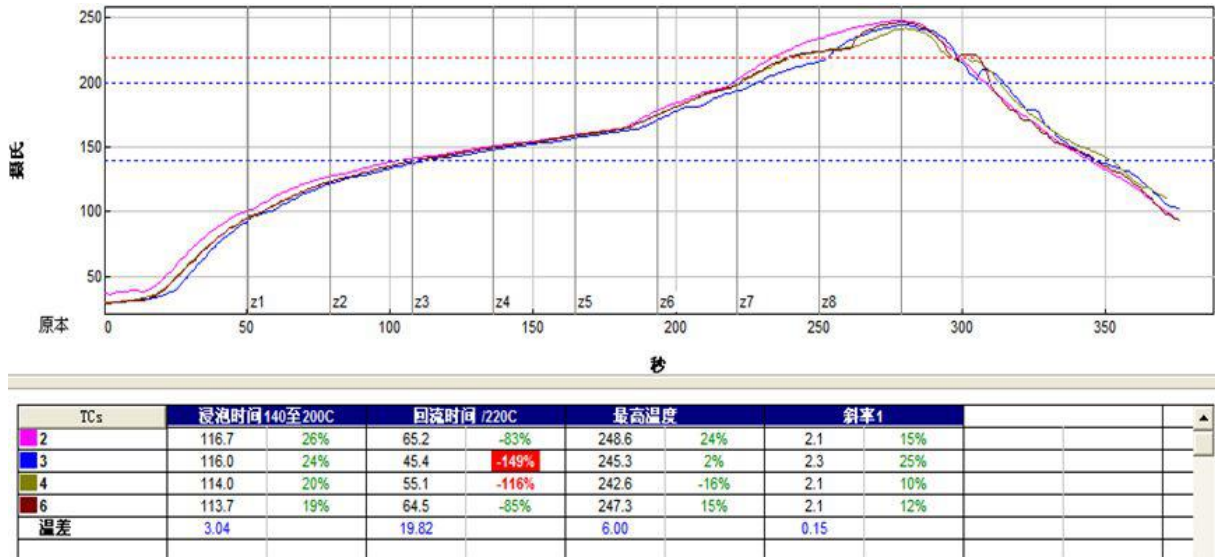
图片19 回流焊接温度曲线图
