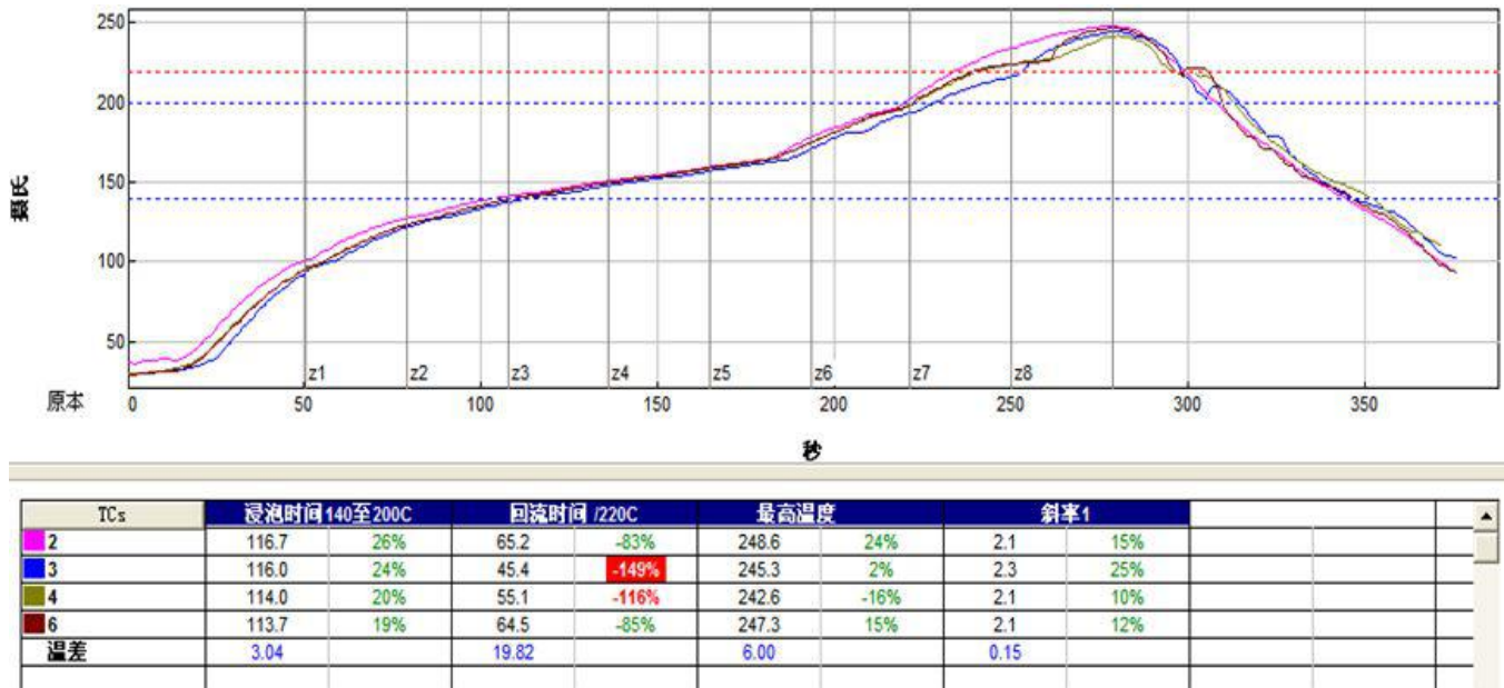
图片 7 回流焊焊接温度曲线图
