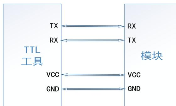
图 1 模块与 TTL 工具连接
