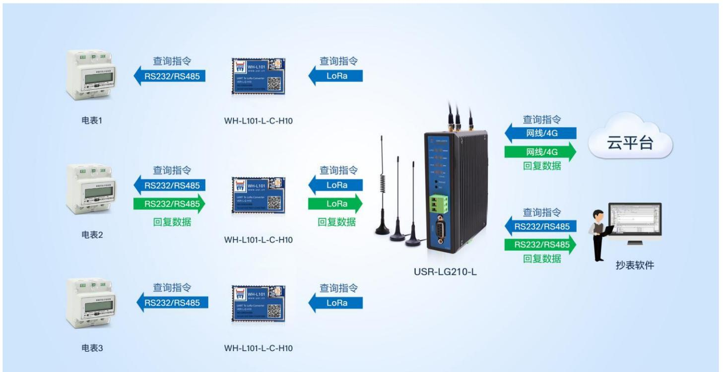
图 8 Modbus 抄表系统示意图
