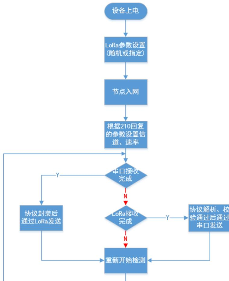
图 12 组网模式流程图
