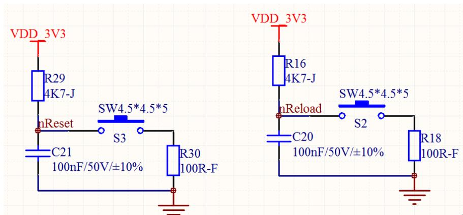
图 6 nReload 和 nReset 设置控制电路图
