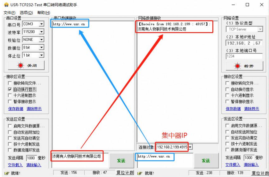
图 6 透明传输通信过程
