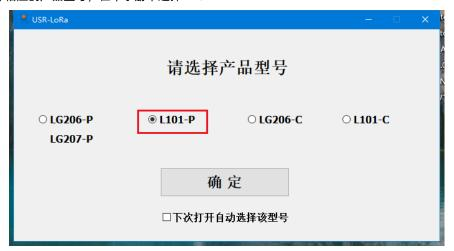
(3) L101-L-P 出厂默认的串口参数是 115200,N,8,1,打开串口。点击进入配置状态,如果模块如下图第 3 步返回了+ok 的字符,说明模块进入配置状态成功,读取参数,可以看到模块目前的参数设置。
