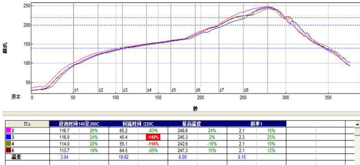
图片 8 回流焊焊接温度曲线图
