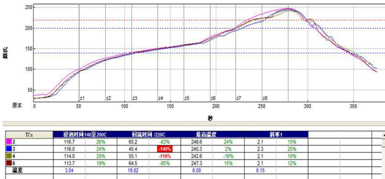
图片 13 回流焊焊接温度曲线图
