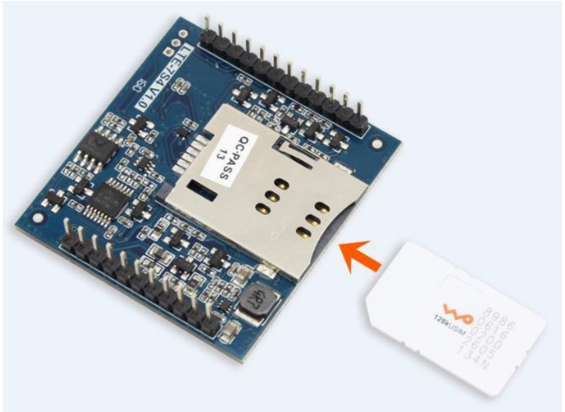
图片10 SIM 卡 插卡方向
