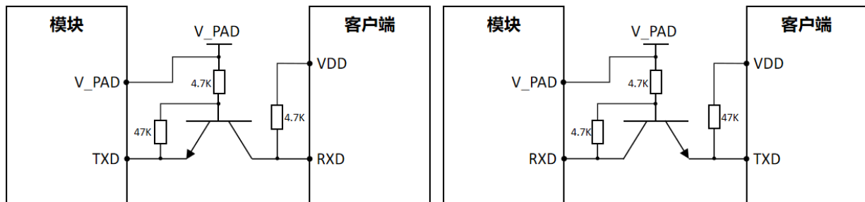
图片5 UART 电平转换参考设计
