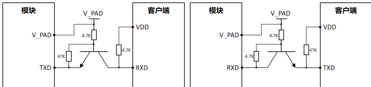
图片5 UART 电平转换参考设计
