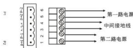
将电源线插入 6 芯接线端子的规定位置，把接线端子插入标准电源接入口(第一路电源 P1 对应的 P+1、P-1 输入，第二路电源为 P2 对应的 P+2、P-2 输入)，支持电源可用电压标准在 12V-52V。
