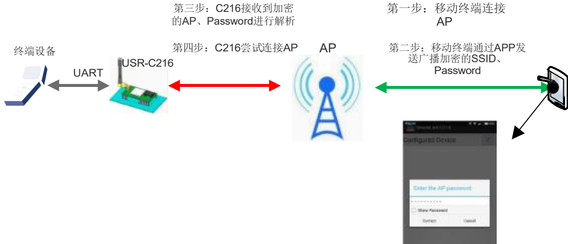
图 21 Simple config 配置流程
