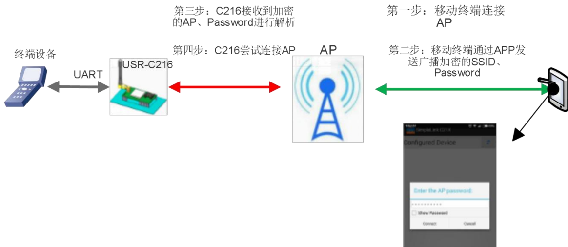
图 24 Simple config 配置流程
