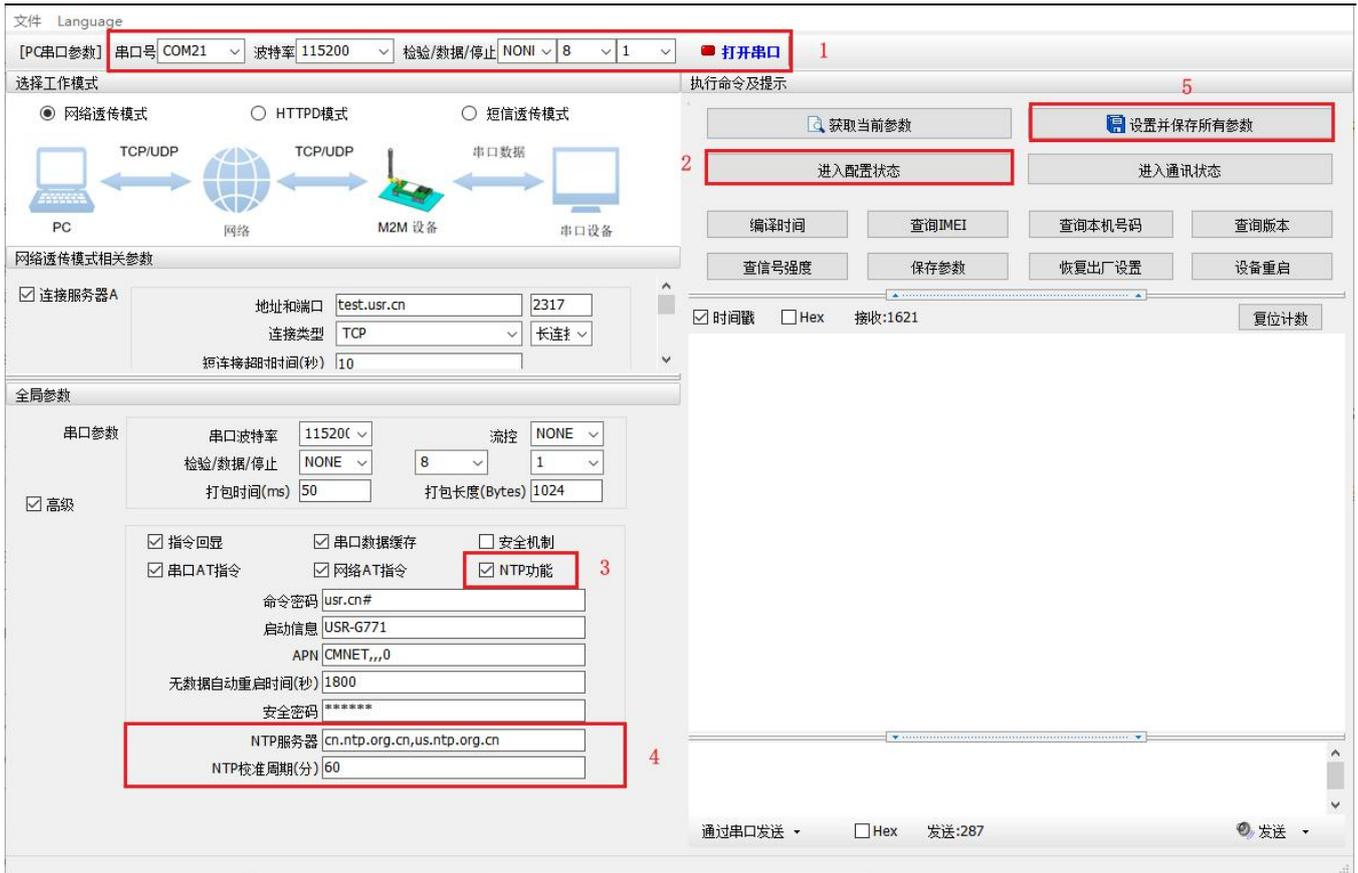
图 25 NTP 服务设置示意图
