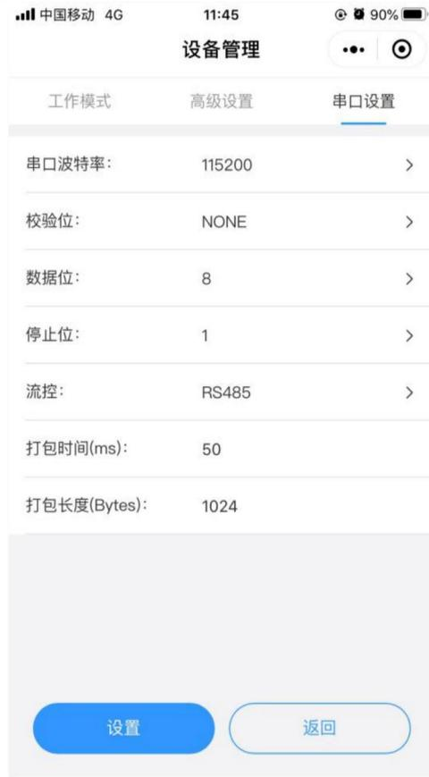
图 44 USR-DR15X 串口设置界面示意图
