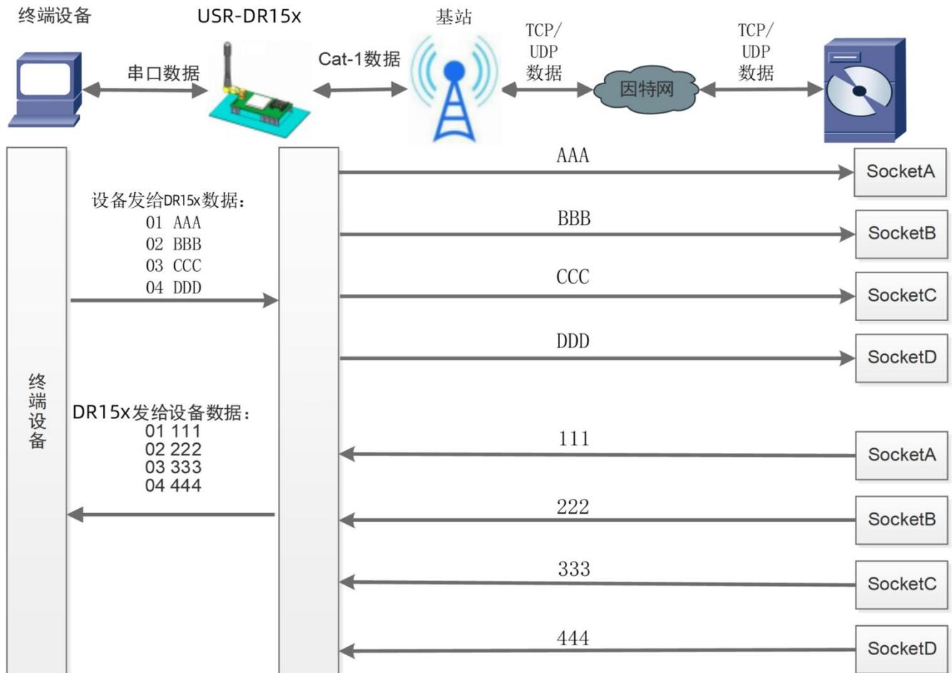
图 20 套接字分发协议示意图
