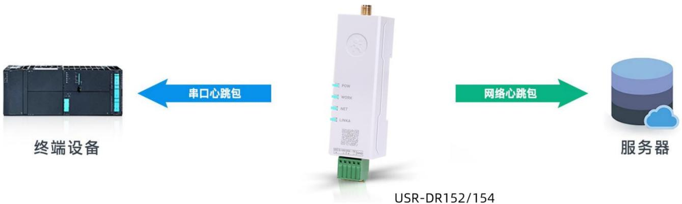
图 18 心跳包发送示意图
