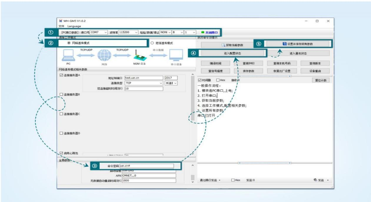
图 34 命令密码设置流程示意图
