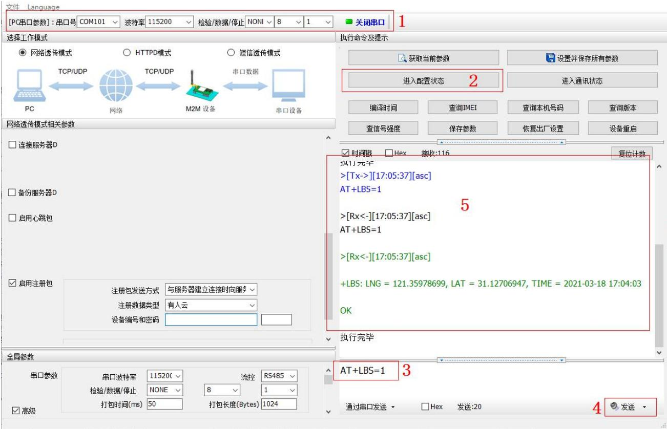
图 27 基站定位查询示意图
