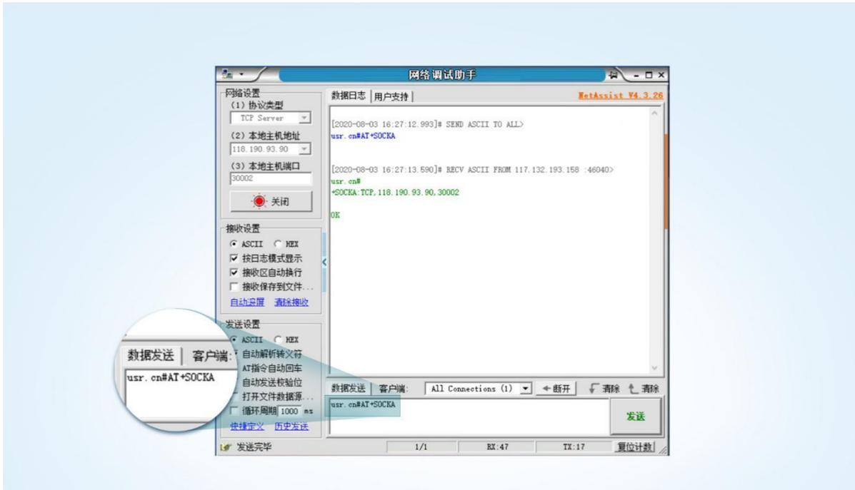
图 37 网络 AT 指令查询示意图
