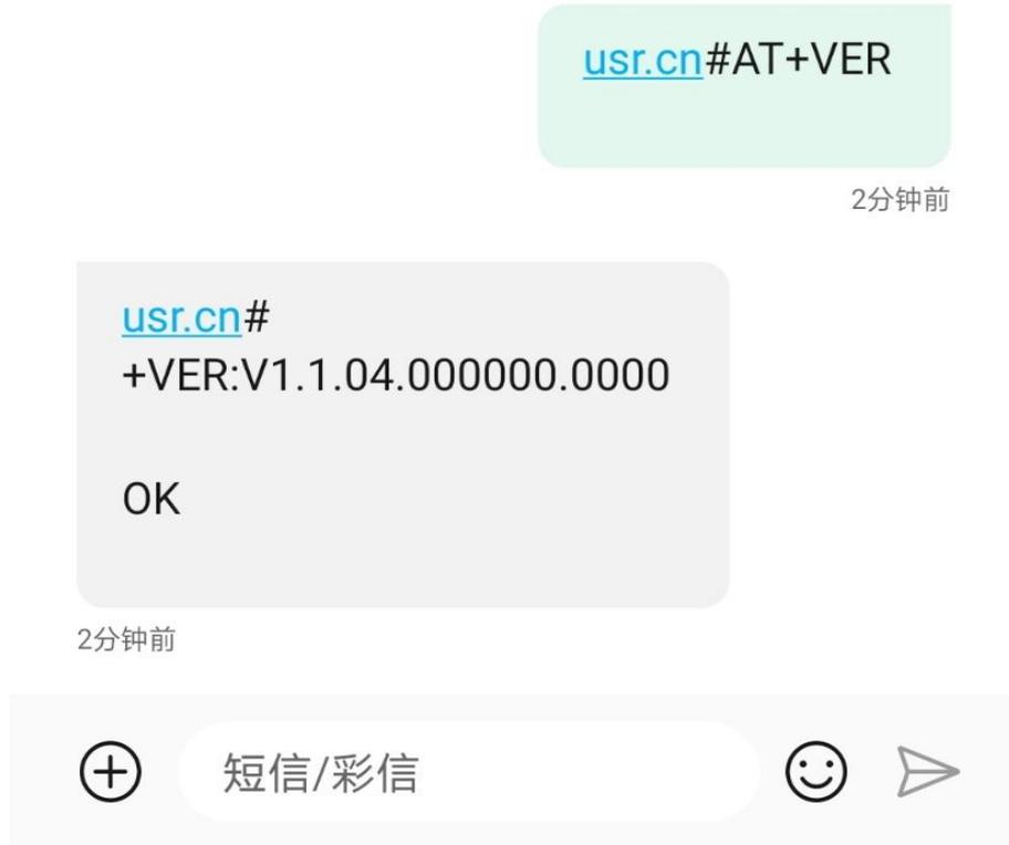
图 38 短信 AT 指令查询示意图
