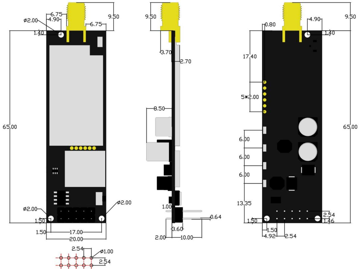
图 4 USR-DR150 插针式 TTL 核心板尺寸图
