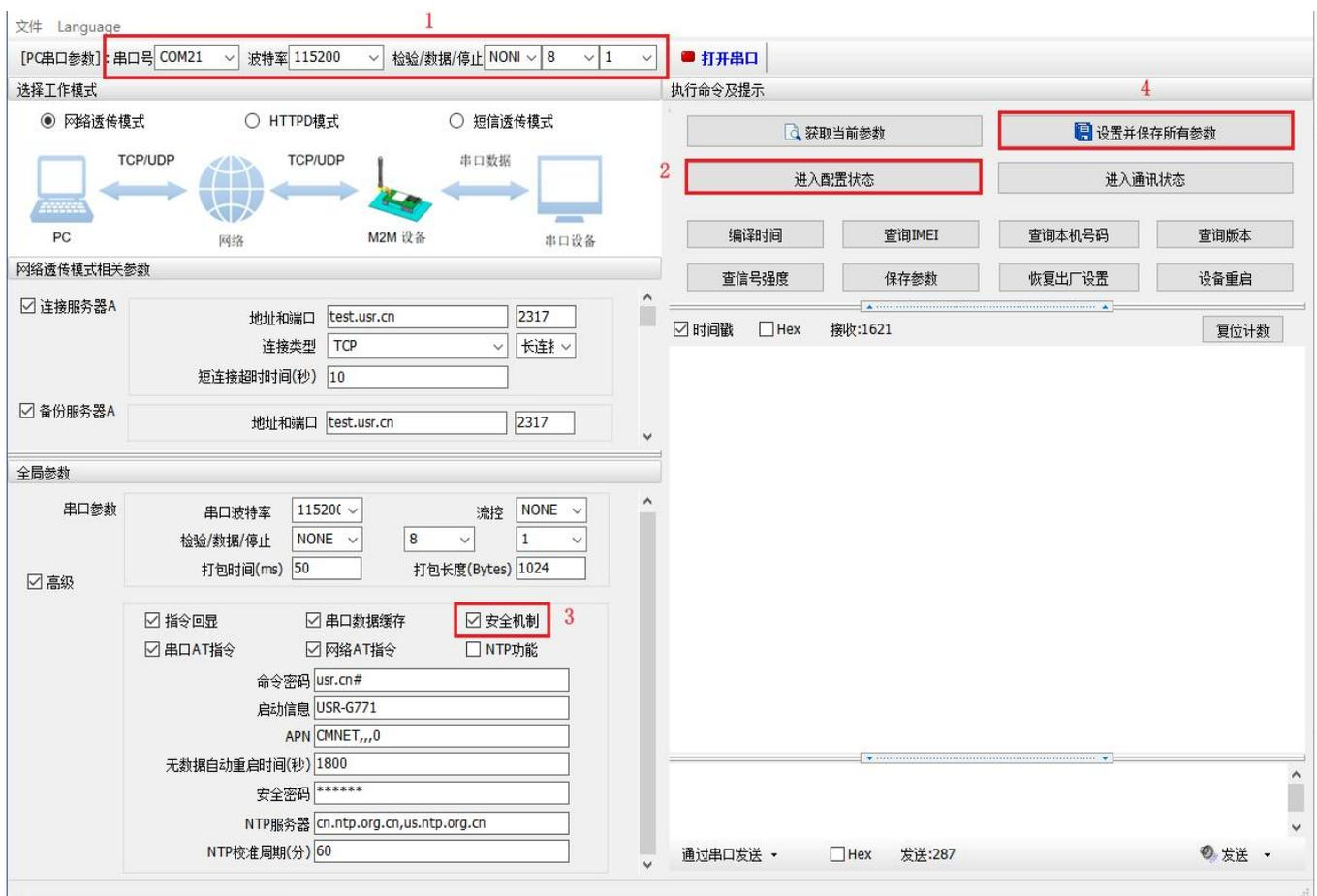
图 24 安全机制设置示意图
