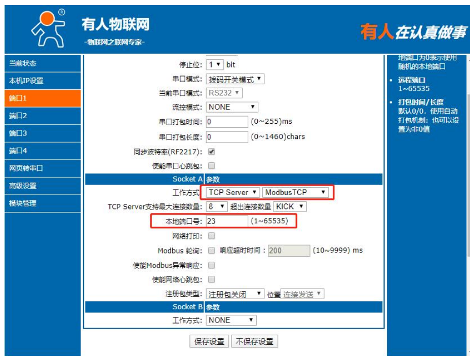
图 47 Modbus RTU 转 Modbus TCP
