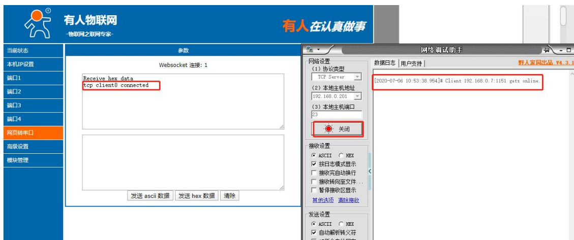
图 36 Websocket 检测设备 TCPC 建立连接
