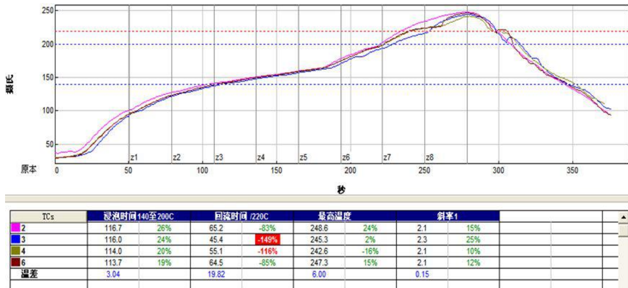
图片 11 回流焊焊接温度曲线图
