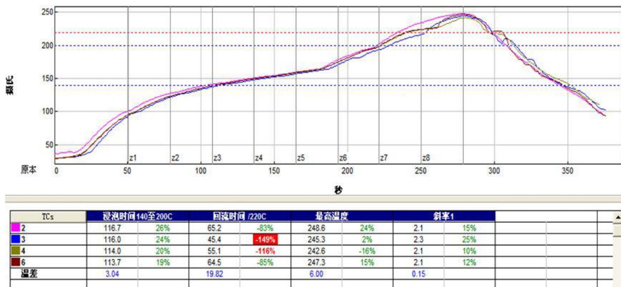
图片 19 回流焊焊接温度曲线图
