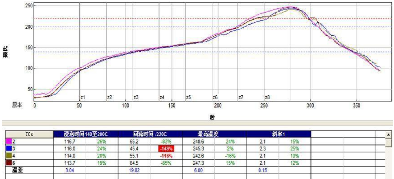
图片8 回流焊焊接温度曲线图
