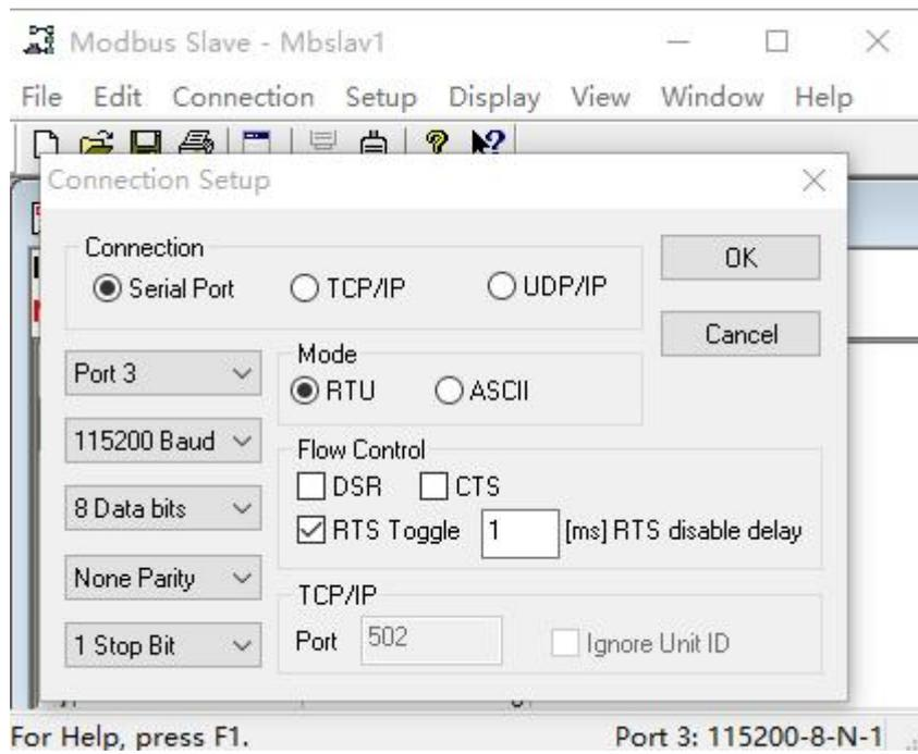
图 49 Modbus RTU 主动查询设置截图
