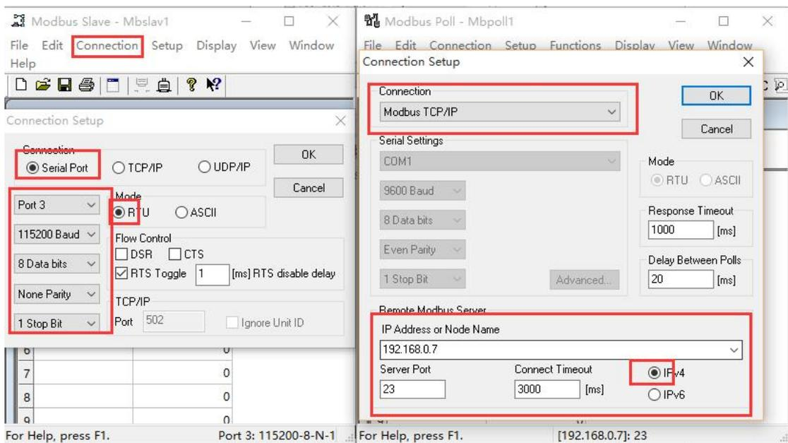
图 46 Modbus RTU 转 Modbus TCP 软件设置截图
