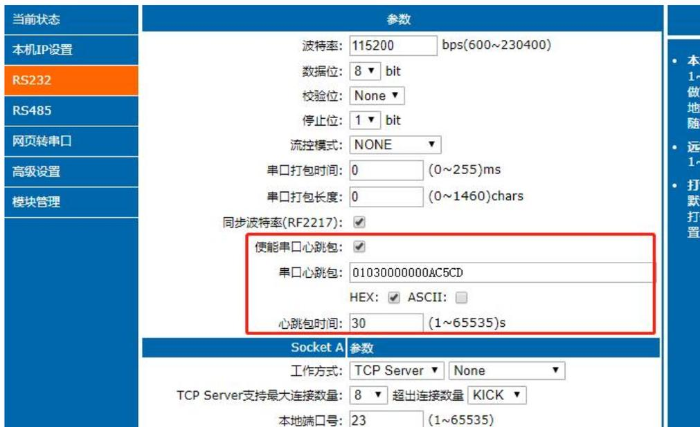
图 48 Modbus RTU 主动查询设置截图
