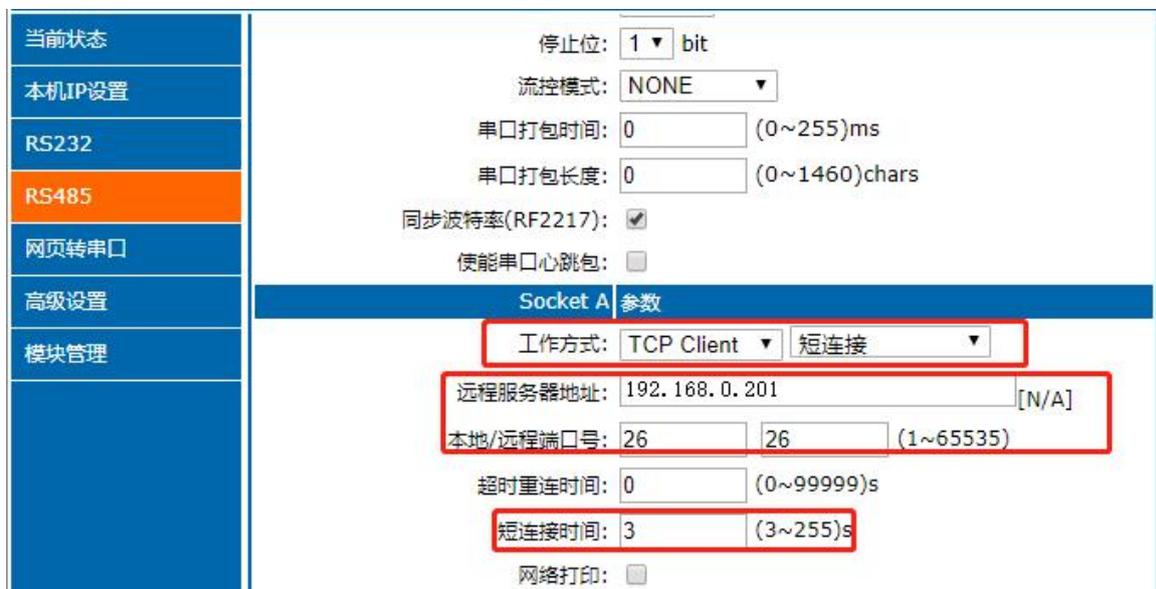
图 69 短连接设置图示
