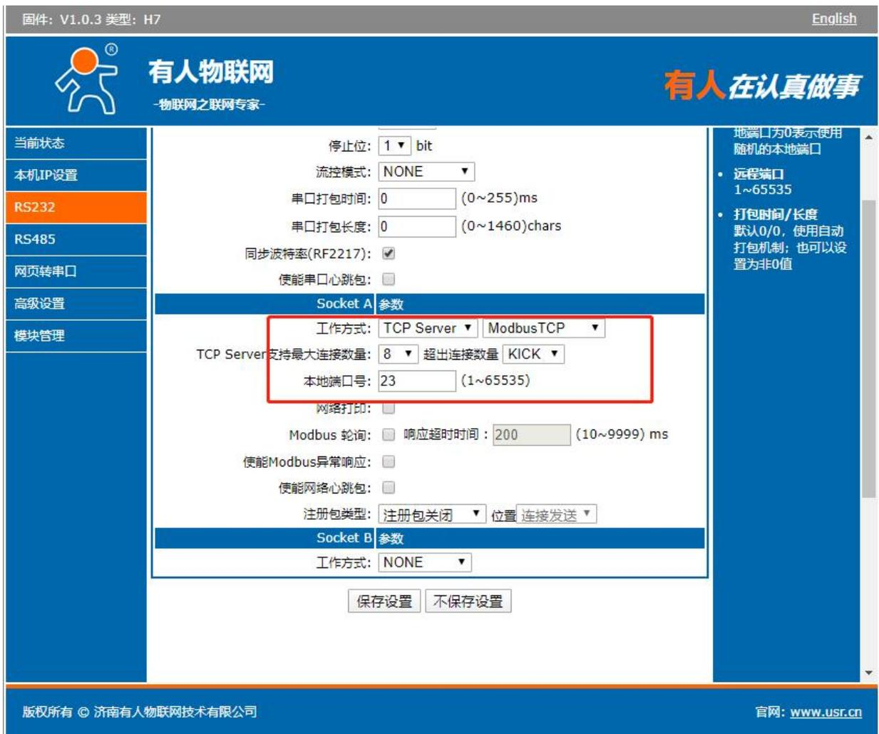
图 45 Modbus RTU 转 Modbus TCP
