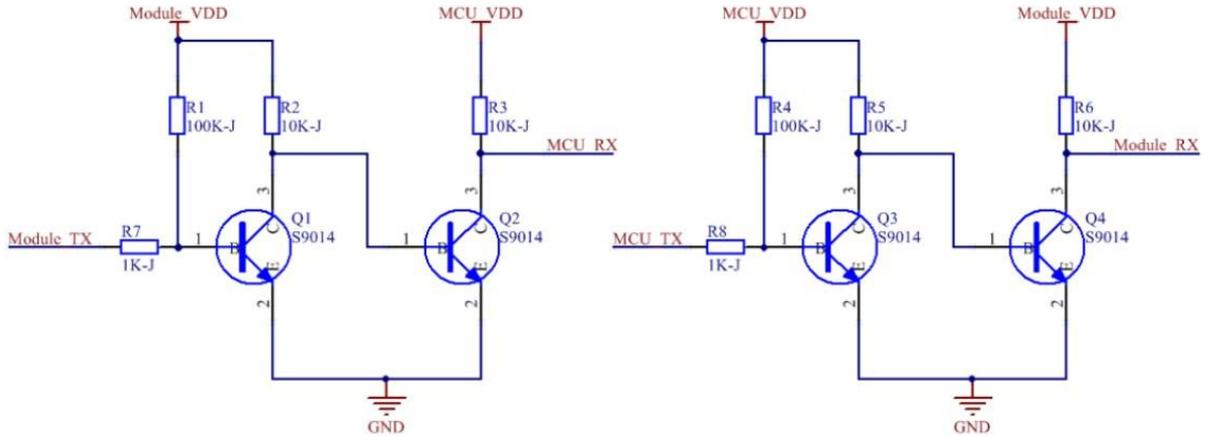
图 5 UART 电平转换参考设计
