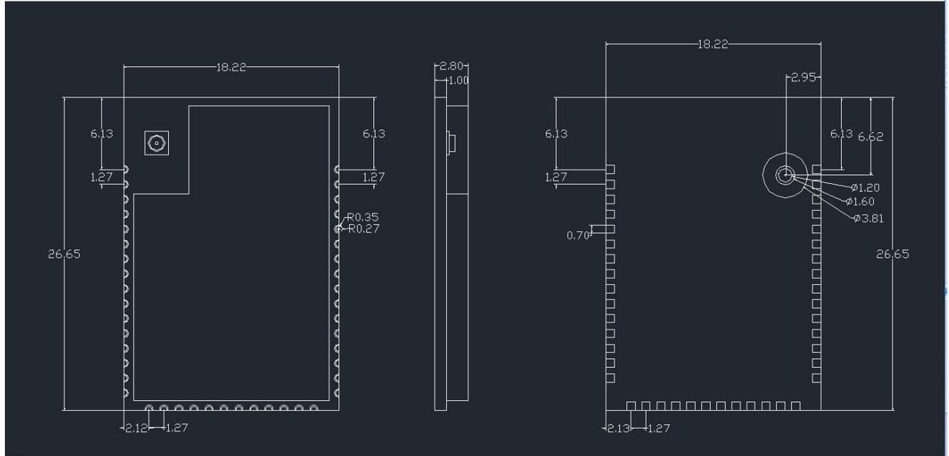
图 10 Layout 推荐封装尺寸
