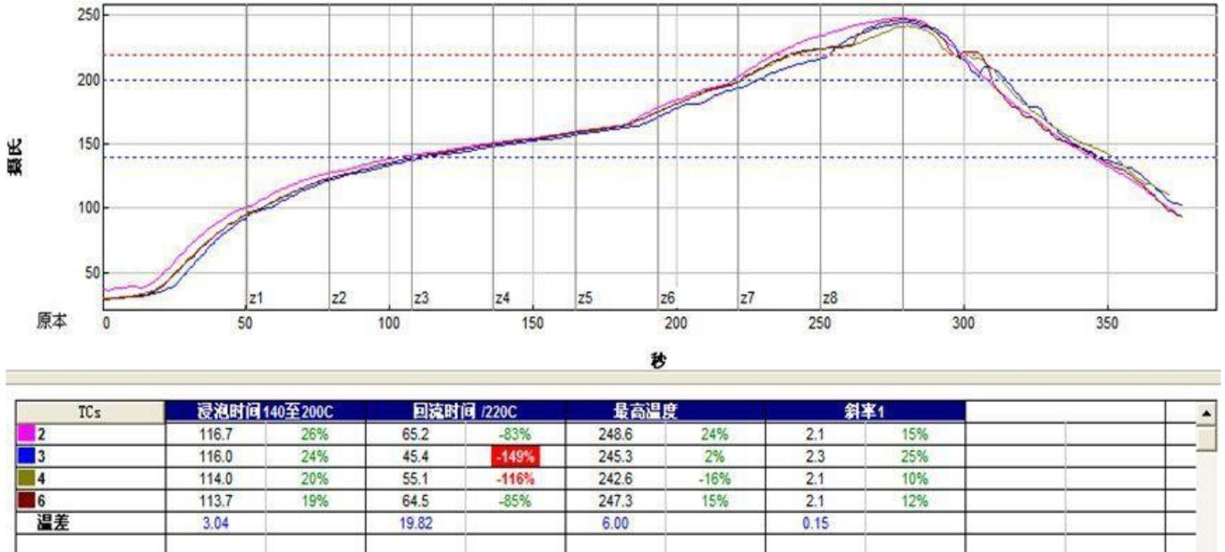
图 8 回流焊焊接温度曲线图
