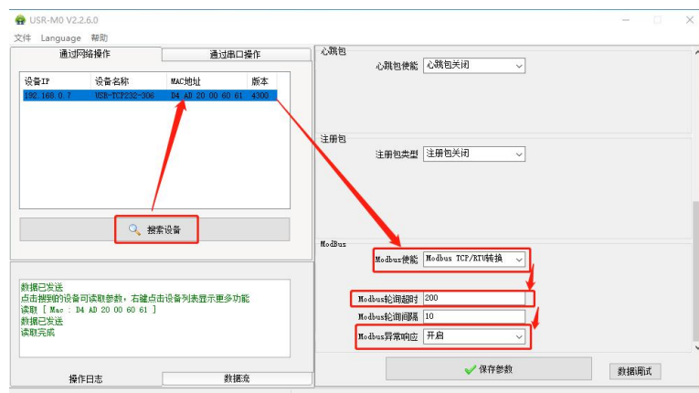
图 22. 软件设置 Modbus 协议转换
