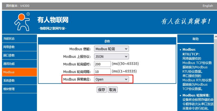
图 26. Modbus 异常响应功能设置
