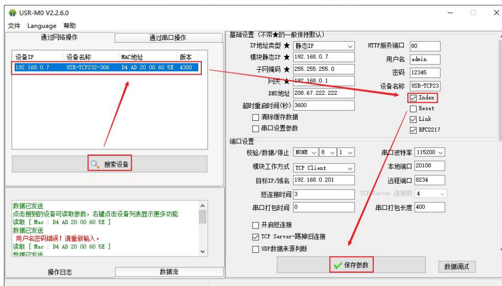
图 35. Index 设置示意图
