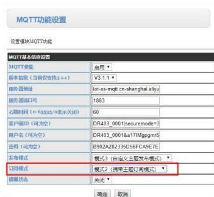
图 92 MQTT 设置订阅模式 2 页面
