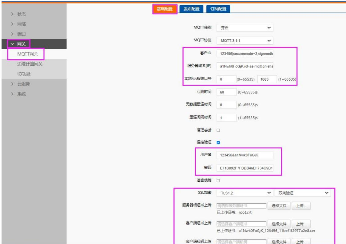
(4) 发布配置：选择透传模式，将阿里云产品添加的发布主题复制后，填入“Topic 字符串”，主题中的\${deviceName}替换为设备名称。例如发布主题为/a1Nwk0FoGjK/\${deviceName}/user/USR\_M100\_P，替换后主题为/a1Nwk0FoGjK/123456/user/USR\_M100\_P。
