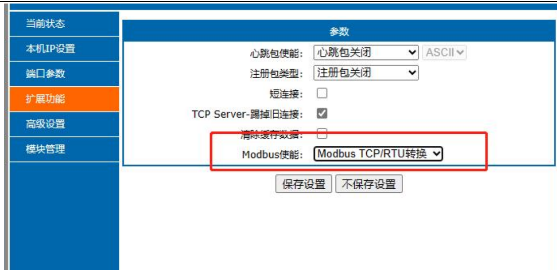
图 42 设置 Modbus TCP/RTU 转换
