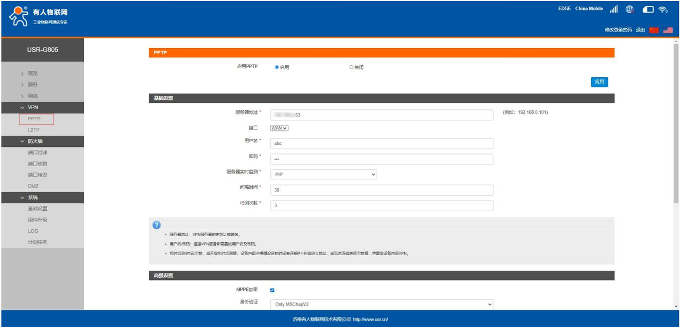
图 48 PPTP 搭建示例：基础设置
