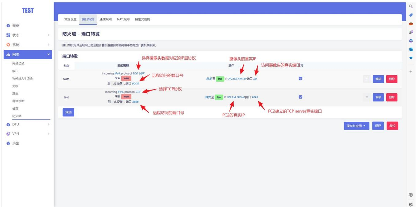
图 57 设置端口转发功能
