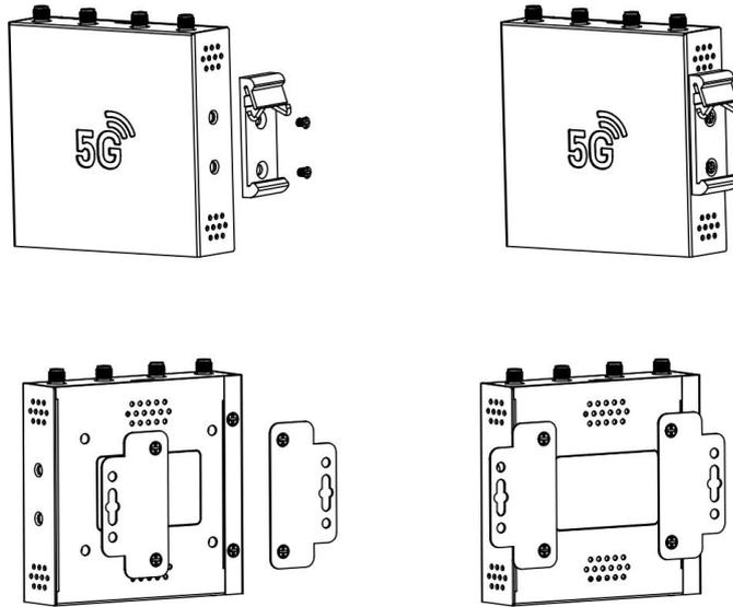
图 1 导轨&挂耳安装方式
