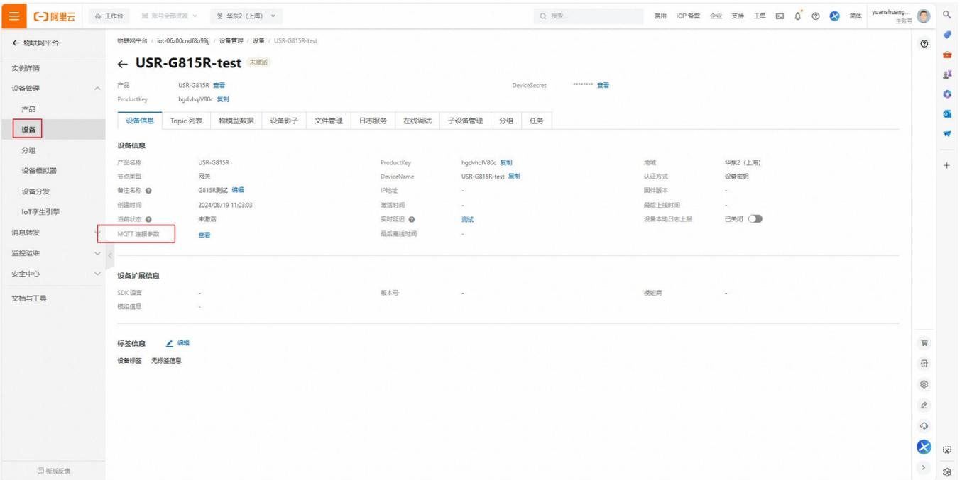
图 86 查询 MQTT 连接参数
