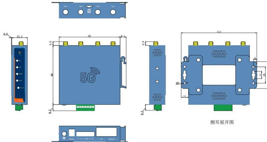
图 2 USR-G815R 尺寸图
