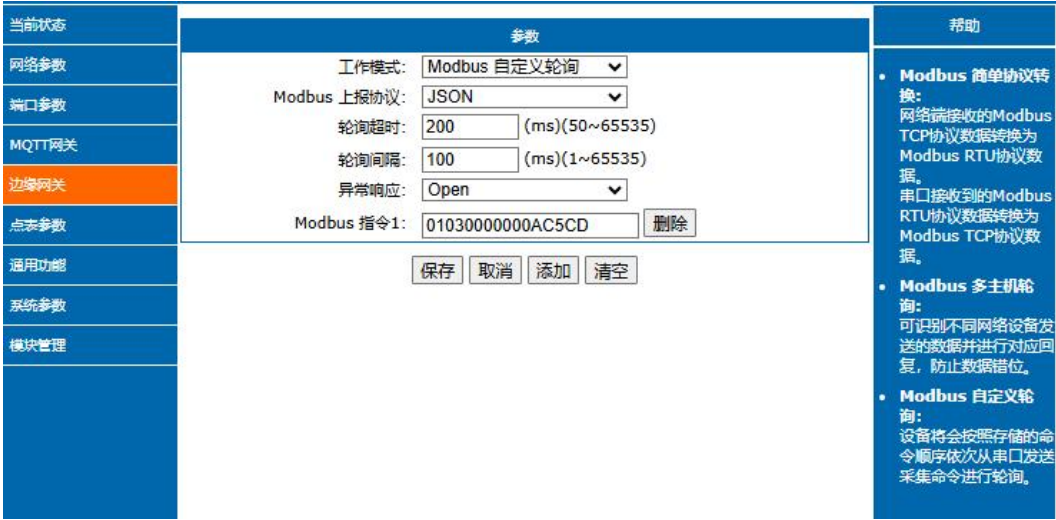
图 47. Modbus 协议轮询指令写入
