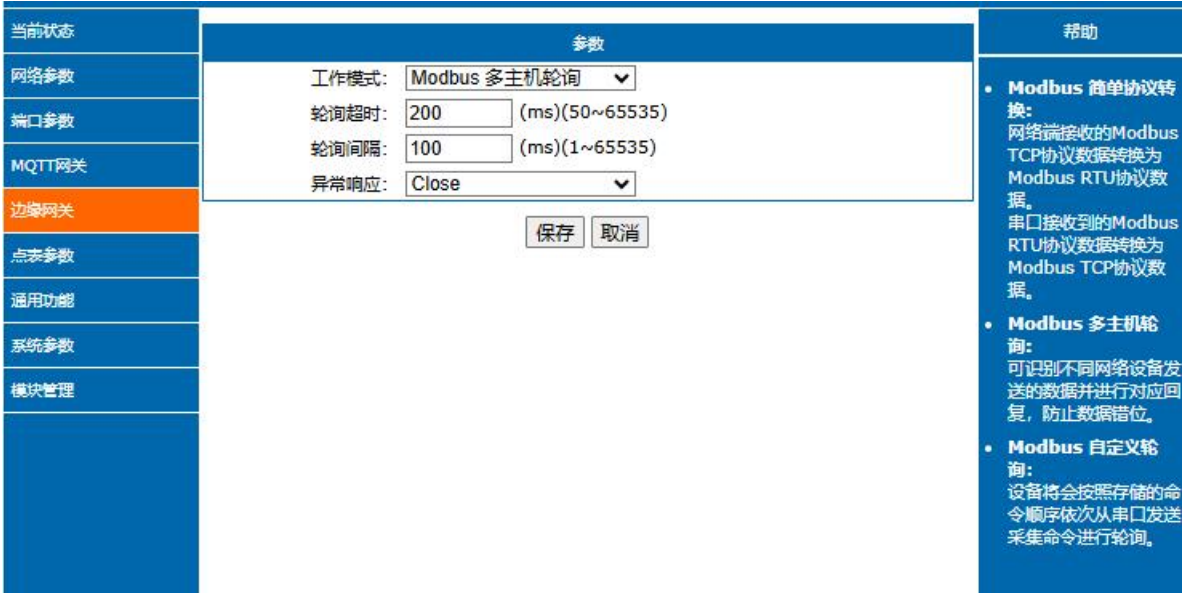
图 43. MODBUS 多主机轮询使能设置图示
