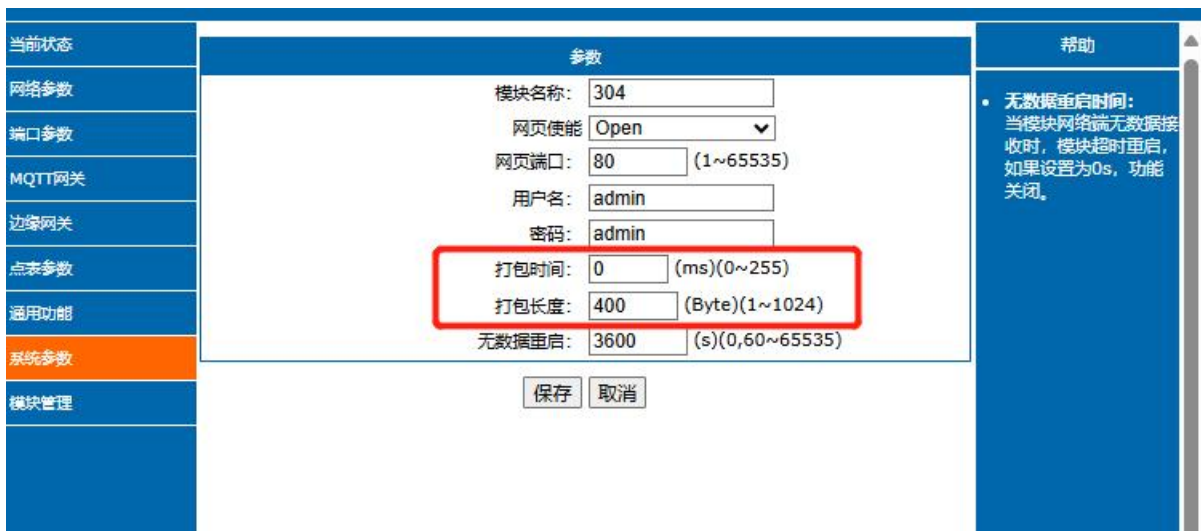
图 6. 串口打包参数配置
