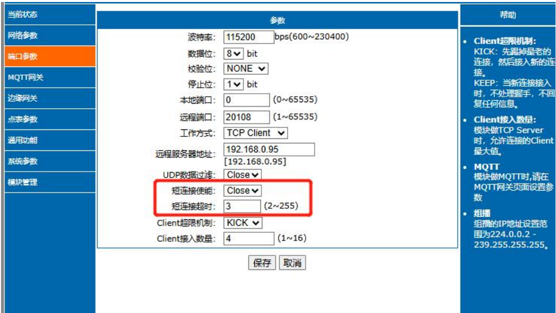
图 13. 短连接设置图示
