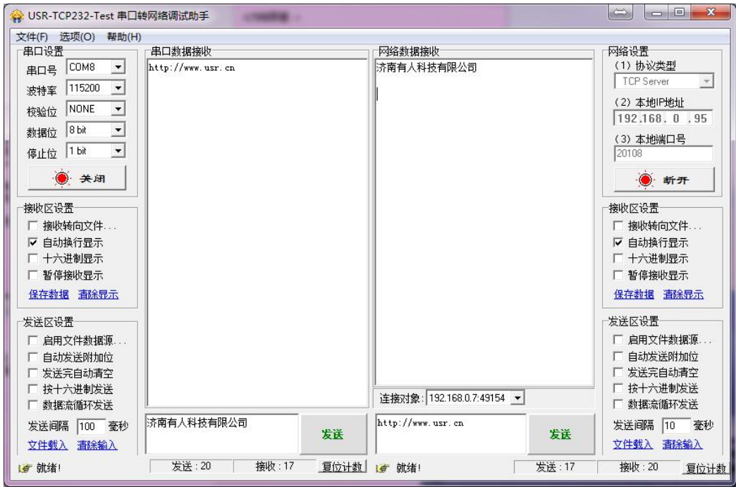
图 12. TCP Client 软件设置
