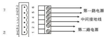
**备注：请按照端处标识连接电源正负极，按照电压范围输入电压 DC12-52V，仅连接一路电源就能正常工作。**
