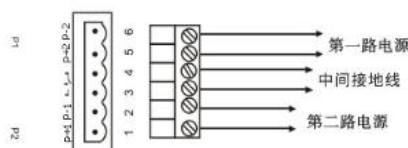
**备注：请按照端处标识连接电源正负极，按照电压范围输入电压 DC12-52V，仅连接一路电源就能正常工作。**
