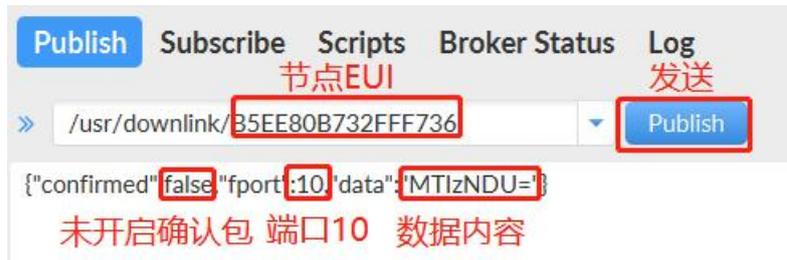
图 17 MQTT 数据下发图示
