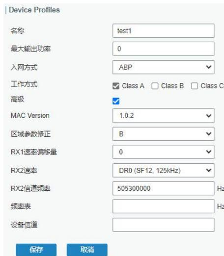
图 25 Profiles 建立参数设置
