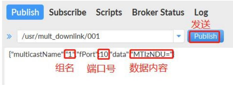
图 18 MQTT 组播下发图示
