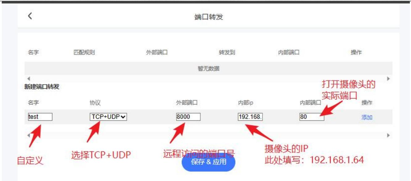
图 42 设置端口转发功能
