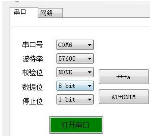
图 25 设置软件串口参数示意图
