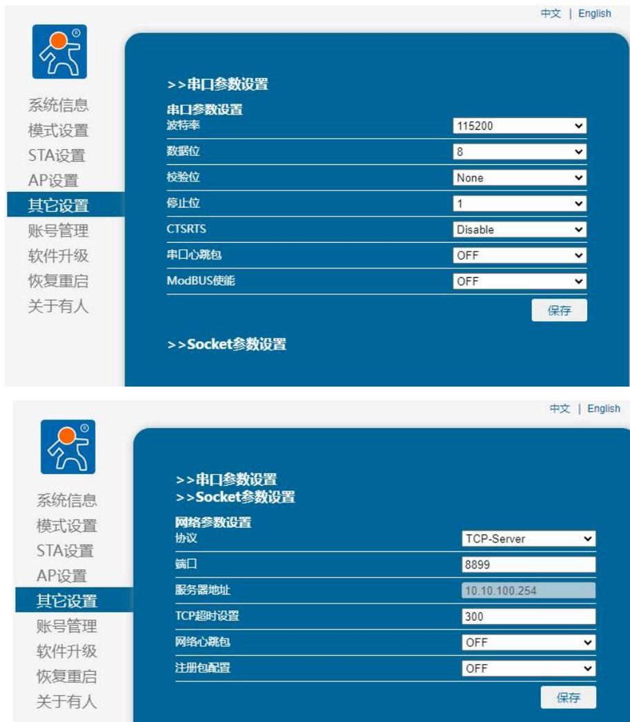
图 19 串口、网络通信配置
