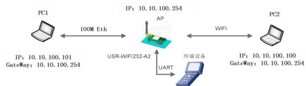
图 16 USR-WIFI232-A2 以太网接口功能（AP）
