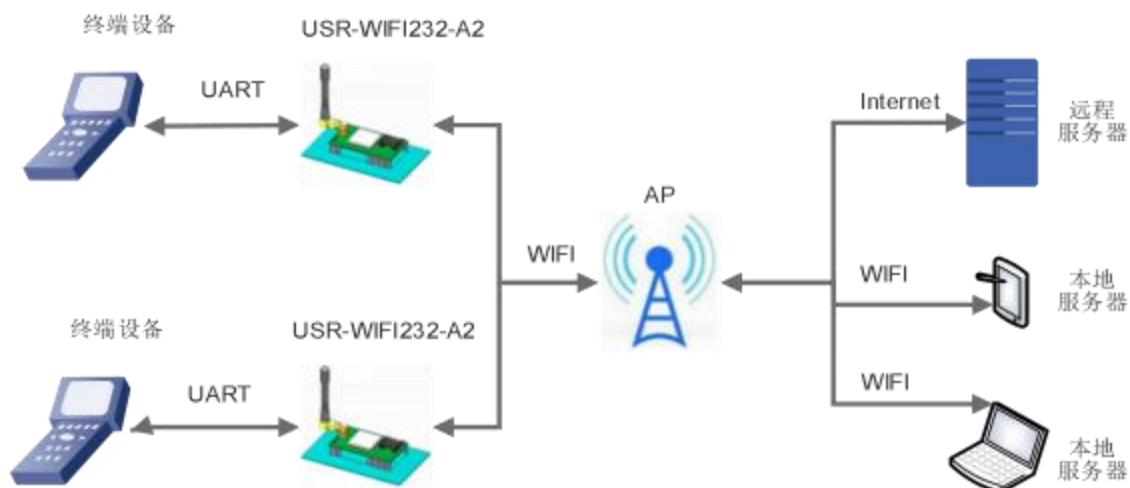
图 11 STA 方式组网
