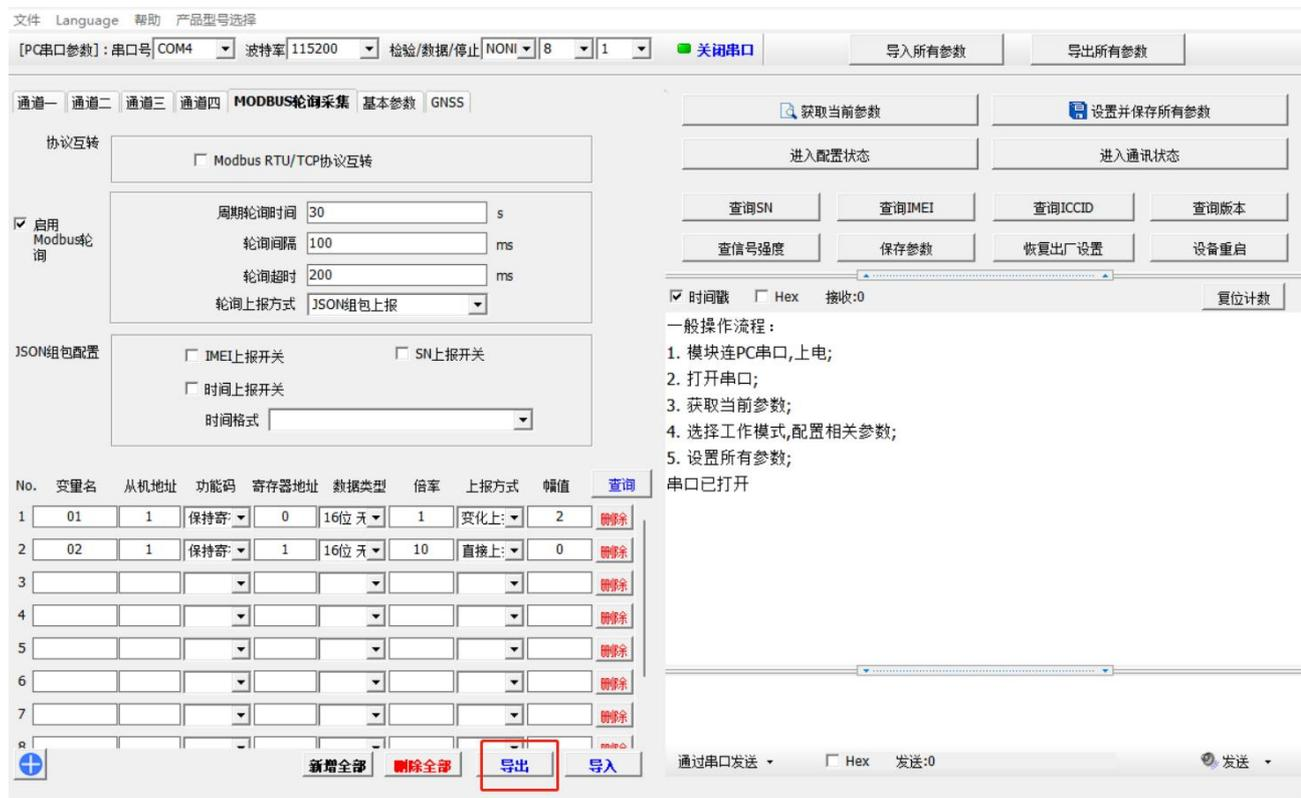
图 5. Modbus 轮询采集点位导出
