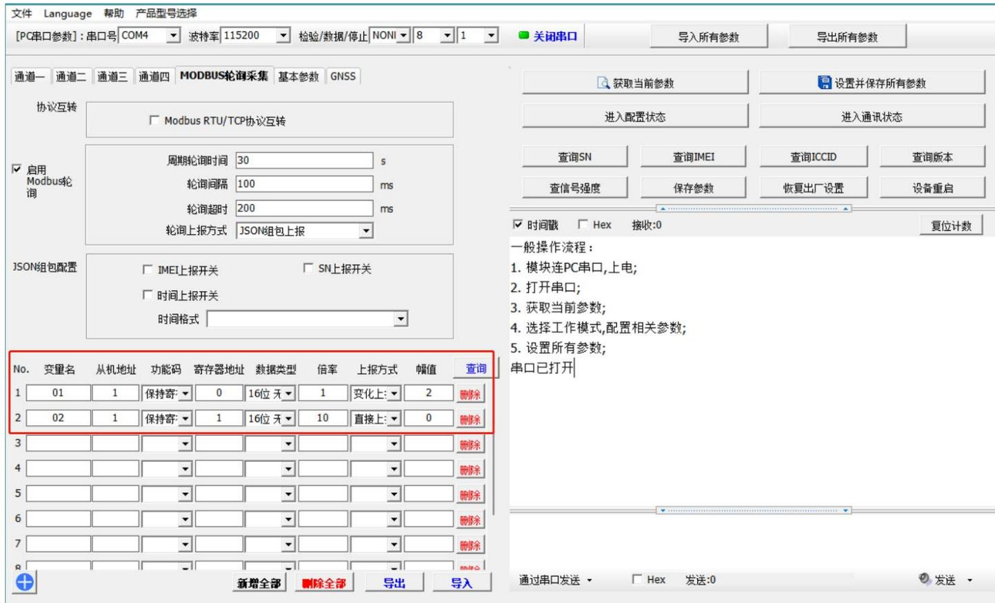
图 4. Modbus 轮询采集点位配置界面
