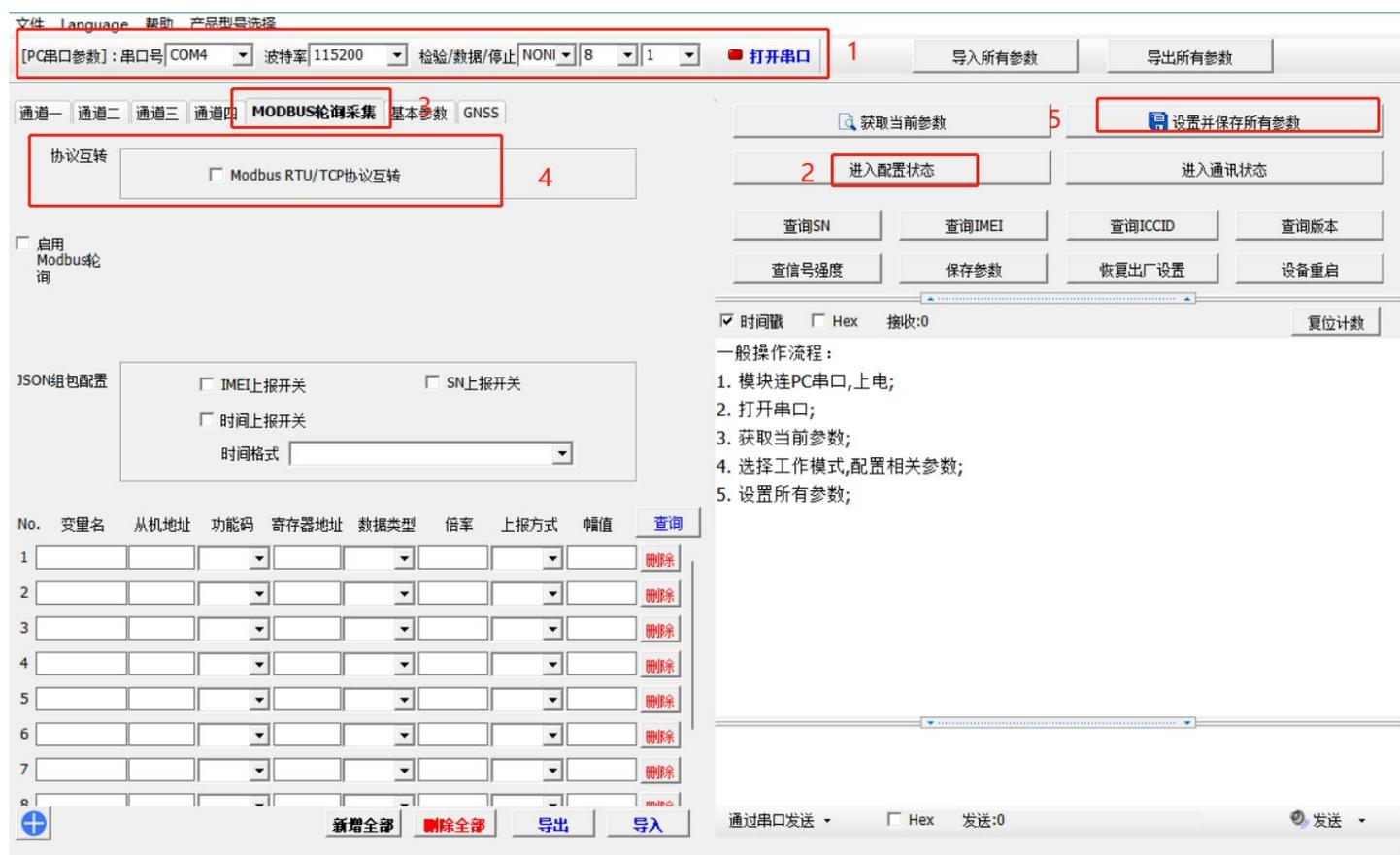
图 1. Modbus 协议转换配置界面
