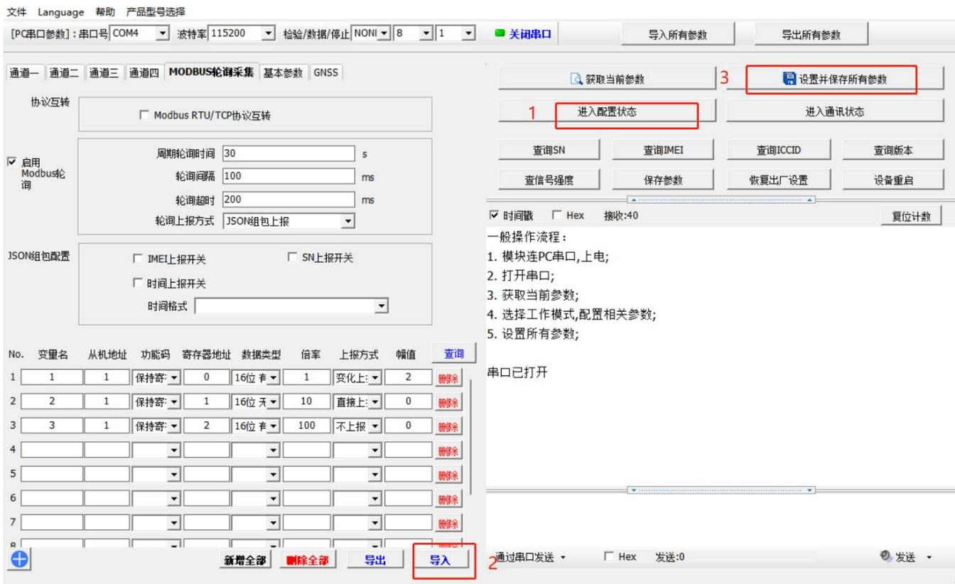
图 7. Modbus 轮询采集导入点表
